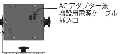
エバジー専用 AC アダプター※1は、左右どちらの挿込口に挿しても動作します。空いた方の挿込口は、エバジー専用増設用電源ケーブル※2を接続する際に使用します。
